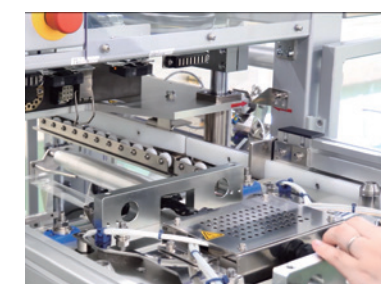
専用ラックをスライドして型替え完了
