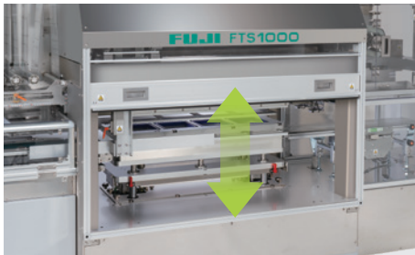
■ シール部カバー：開閉シャッター式
