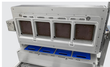
■ 型交換は工具レス、型の清掃も容易
